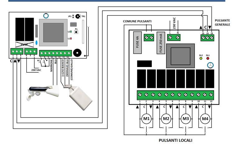
Per collegare un'altra centrale eseguire il collegamento come sopra, il comune va al morsetto 1, il morsetto 5 non si usa, e si deve togliere il fusibile.
